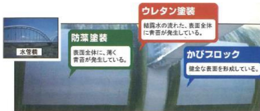
過酷な環境の水管橋表面で暴露しました。(ウレタン塗装は3年、防藻塗装・かびブロックは1年暴露)
